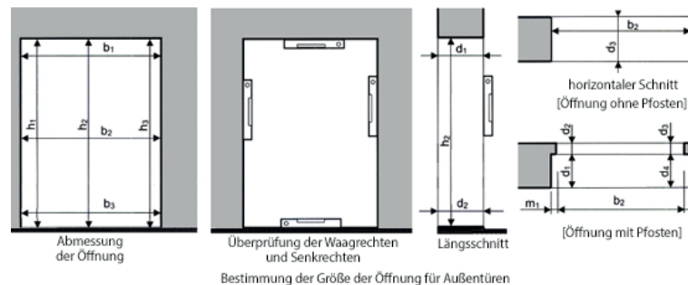
Abb. 2 Abmessung der Wandlaibung: mit/ohne Pfosten
